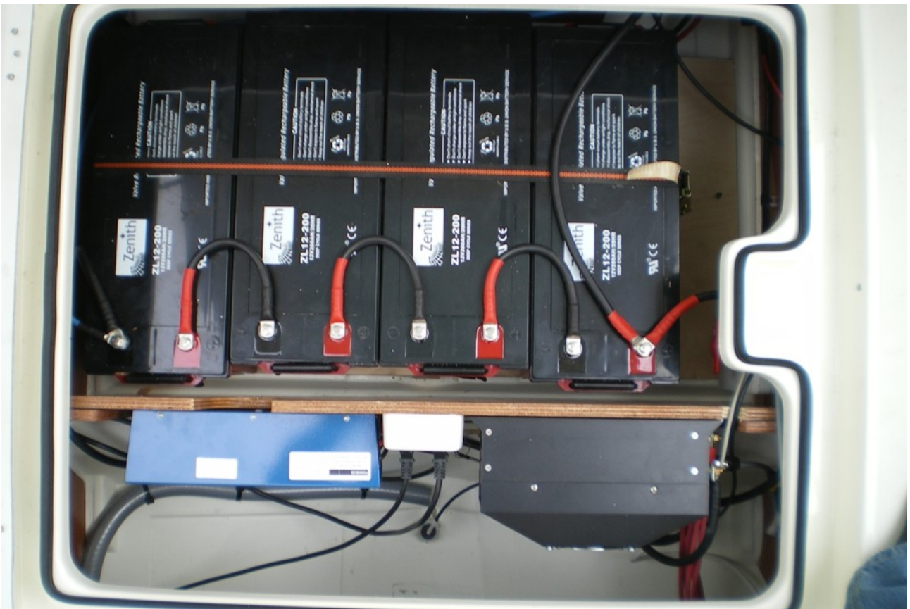
Batterie- und Geräteraum unter der Plicht, maßgefertigte Trägerplatte mit Gurtfixierung
