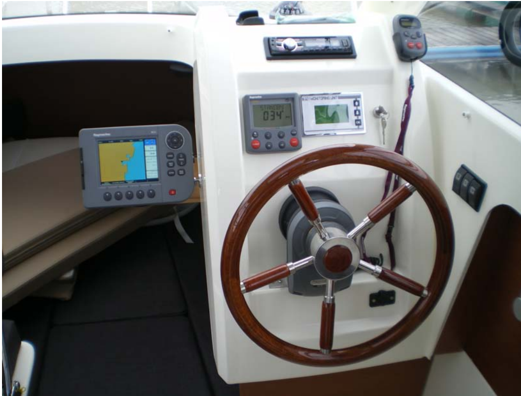
Hier ein Steuerstand ausgerüstet mit Navigation kombiniert mit Autopilot und Funkfernbedienung mit der man von jedem Platz aus das Boot lenken kann
